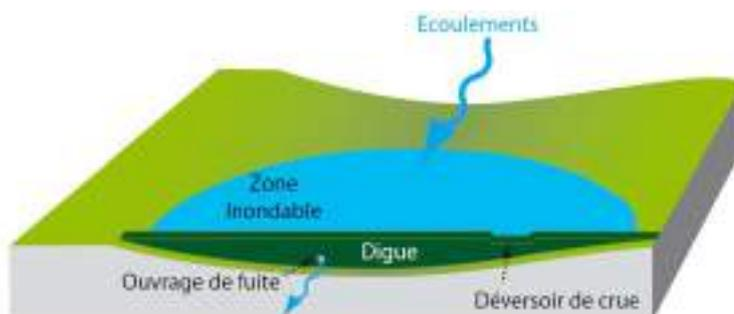
Figure 10 : schéma type d'une zone inondable
