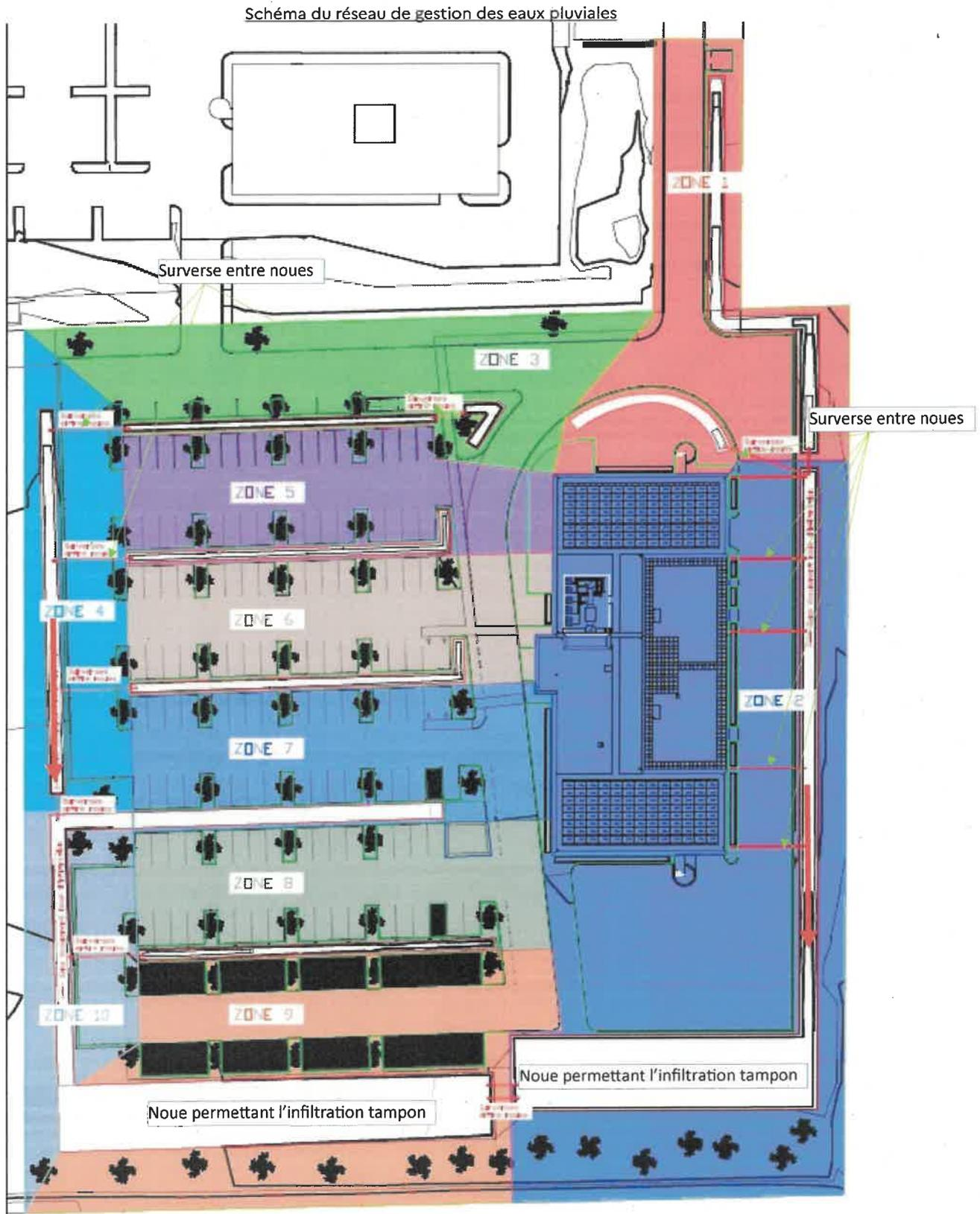
Les eaux de ruissellement des surfaces sont collectées par simple écoulement gravitaire vers les ouvrages.
