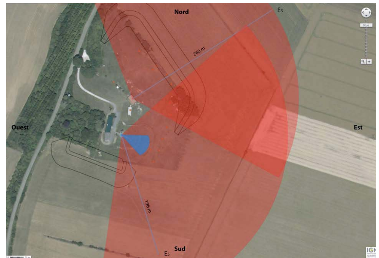
Fig. 2 : Zones de sécurité (en rouge) définies pour les deux postes de tir
