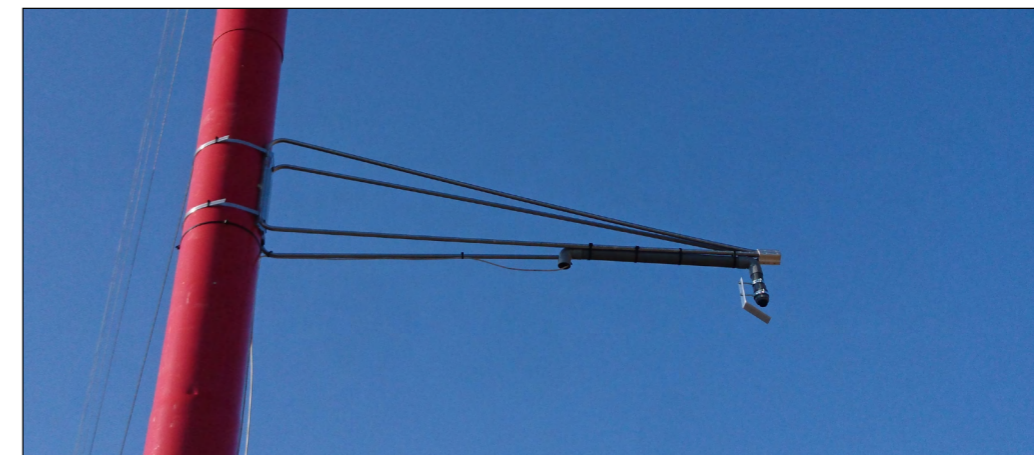
Photo 27 : Micro posé sur un mât de mesures
