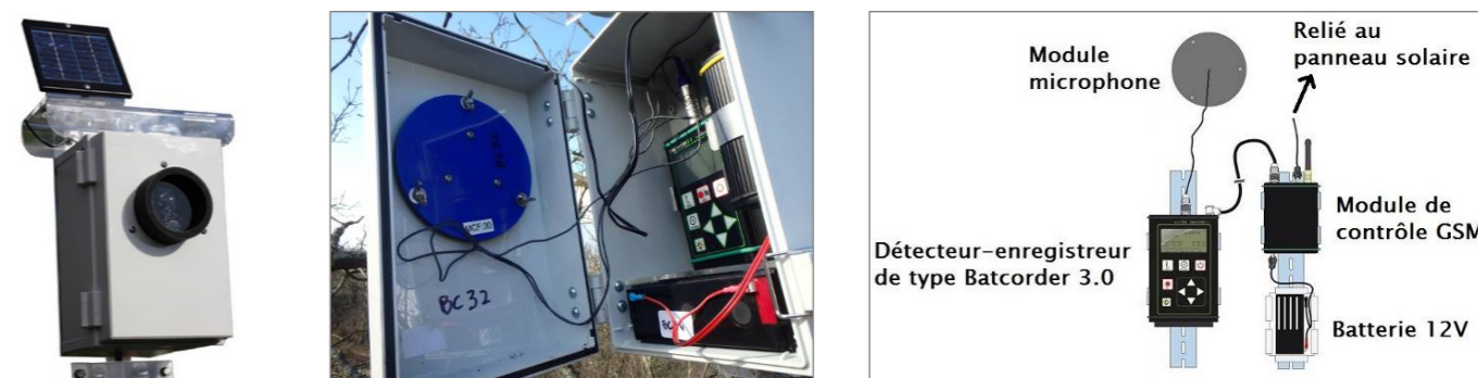
Figure 2 : Boîtier d'enregistrement autonome et montage
