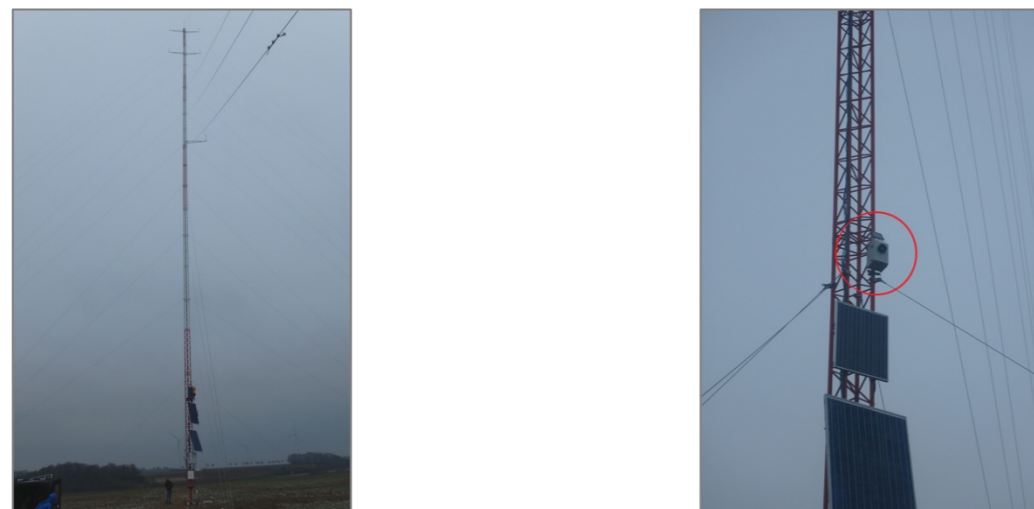
Figure 4 : Batcorders sur le mât de mesures (Source : AXECO)
