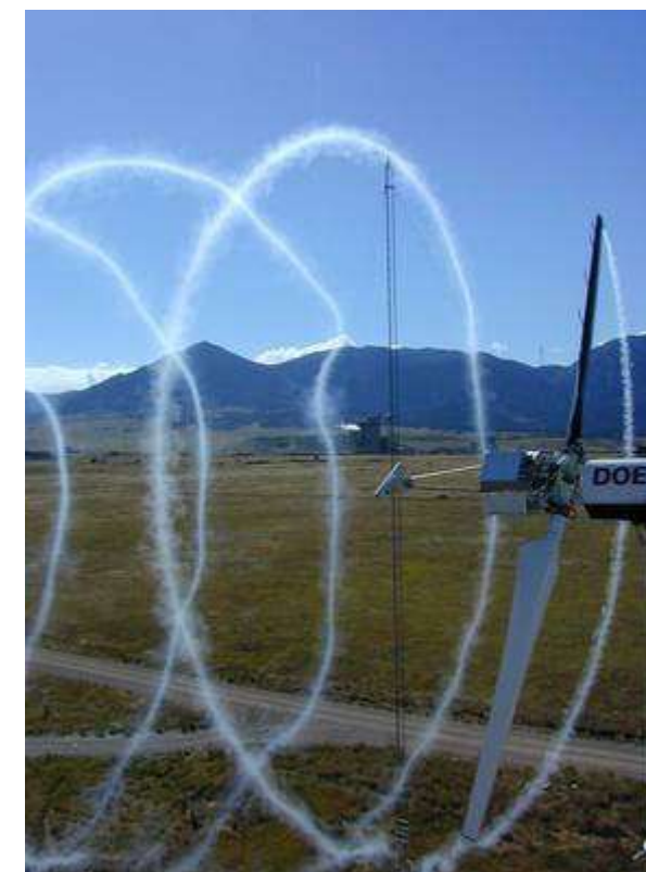
Figure 117 : Effet de sillage derrière une éolienne bi-pale visualisé à l'aide d'un traceur fumée (source : http://www.energieplus-lesite.be )
