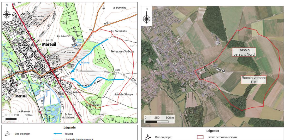
Présentation des bassins versant et talwegs naturels présents en amont du projet
