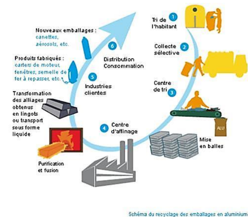
Figure 9 : Schéma du recyclage des emballages en aluminium
