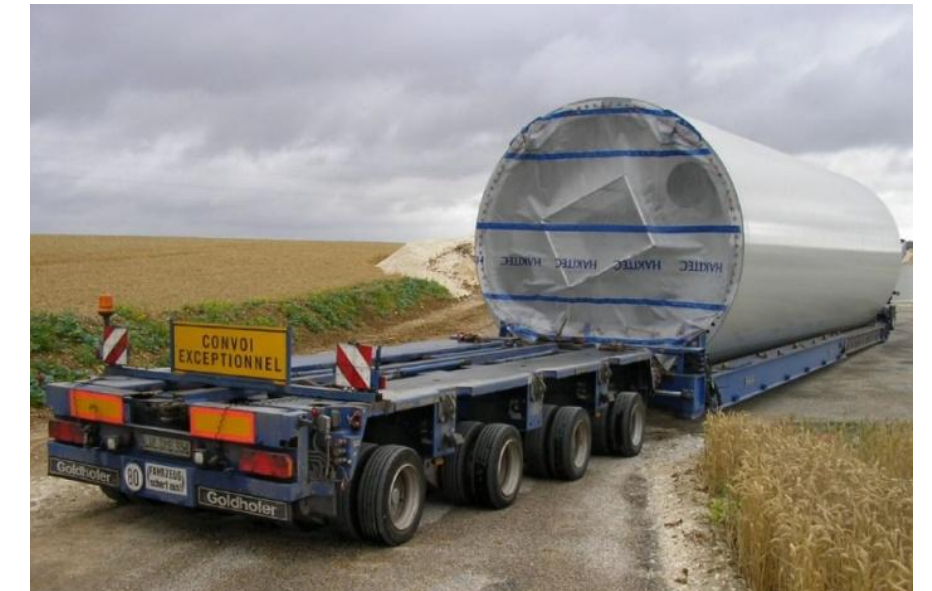
Photo 13 : Transport d'une section de tour d'une éolienne sur site
