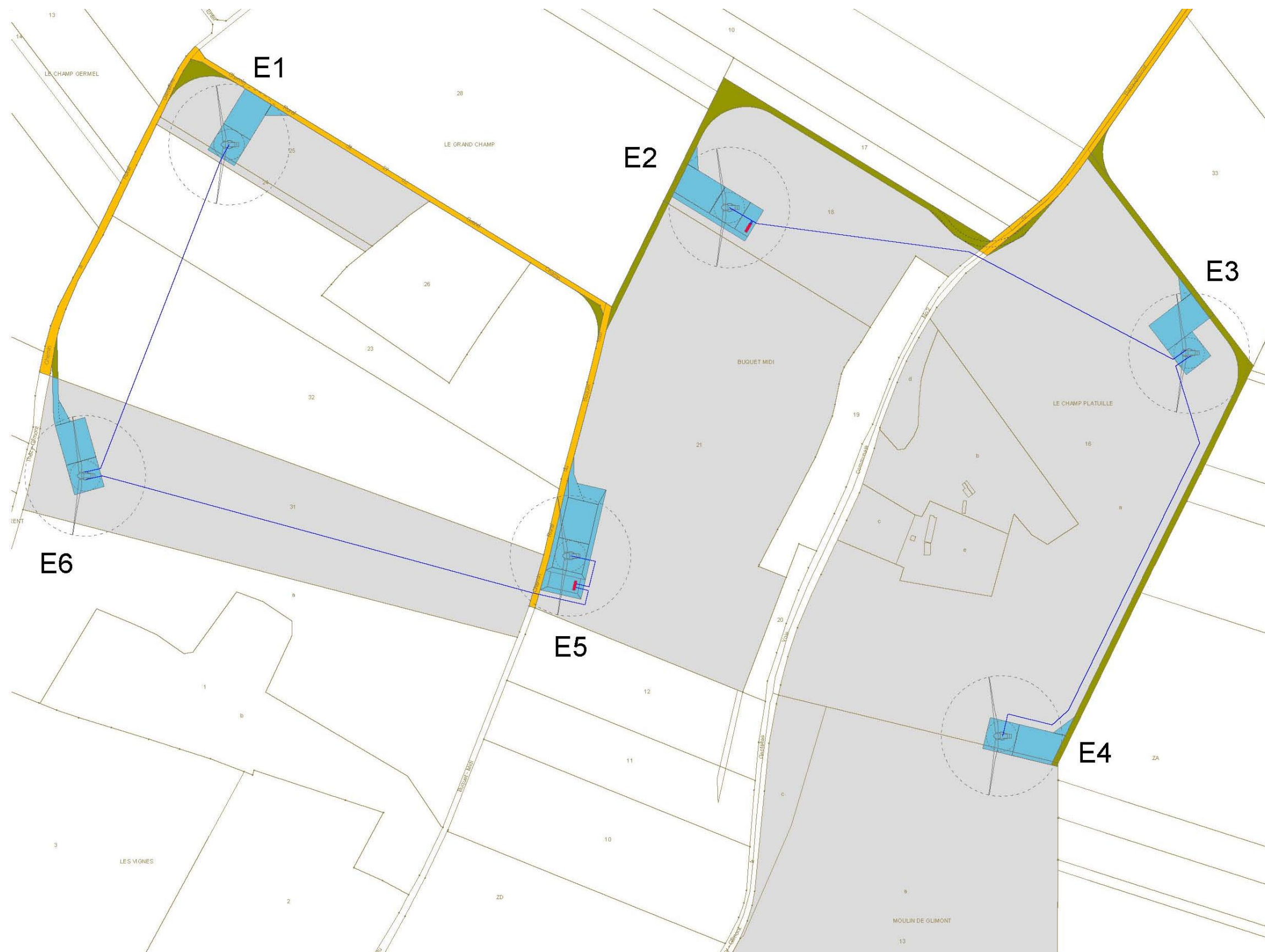
Figure 7 : Cheminement du raccordement électrique inter-éoliennes pressenti
