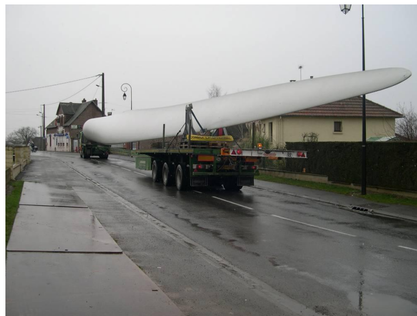
Photo 44 : Camion de transport des pales d'une éolienne
