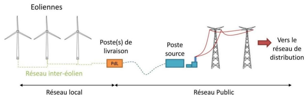
Figure 11 : Raccordement électrique des installations (source : INERIS/SER/FEE, 2012)
