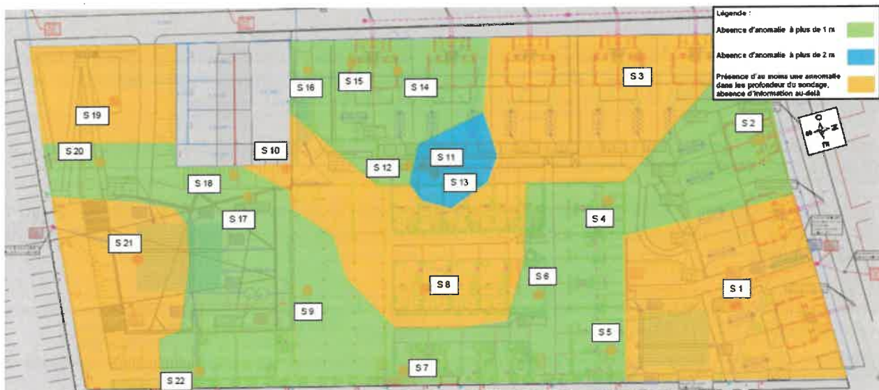
Figure 3: Estimation simplifiée de la profondeur des anomalies relevées sur le site
