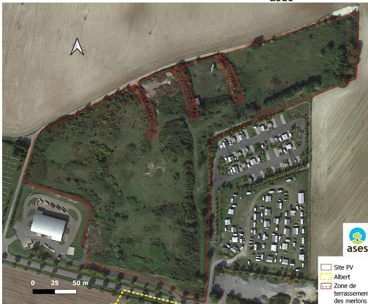
Figure 72 : Zone de terrassement des 3 merlons situés dans la partie Nord du site.
