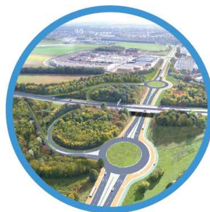
Variante 3 : Echangeur de type demi-trèfle orienté Est
