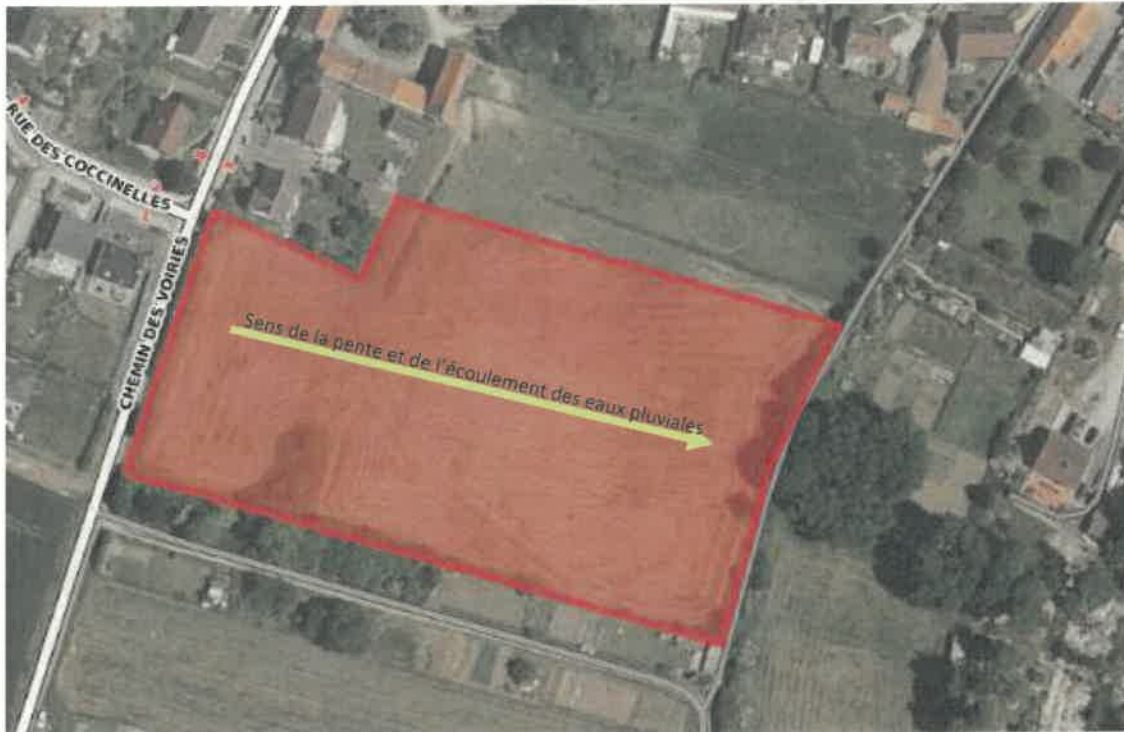
Schéma des écoulements des eaux pluviales
