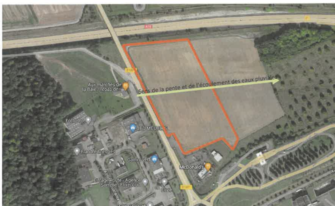
Schéma des écoulements des eaux pluviales
