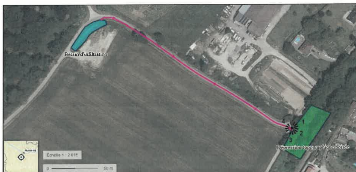
schéma du bassin d'infiltration et de son exutoire naturel :
