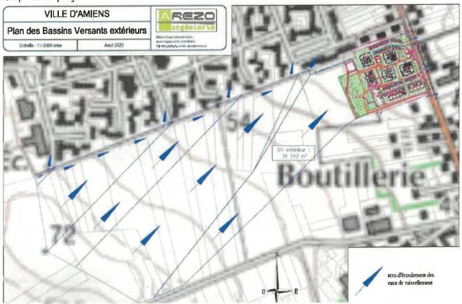
Schéma des écoulements des eaux pluviales après aménagement
