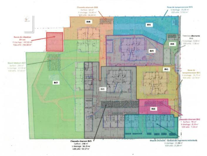
Schéma des ouvrages de gestion des eaux de ruissellement par sous-bassins
